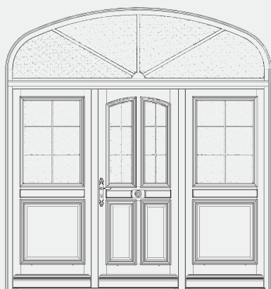
MODÈLE LANGUEDOC AVEC FLÈCHE DE 100 MM + 2 FIXES BATTANTS VITRÉS HAUT + IMPOSTE EN ANSE DE PANIER AVEC PETITS BOIS RAYONNANTS COLLÉS 2 FACES. H 2950 L 2740
