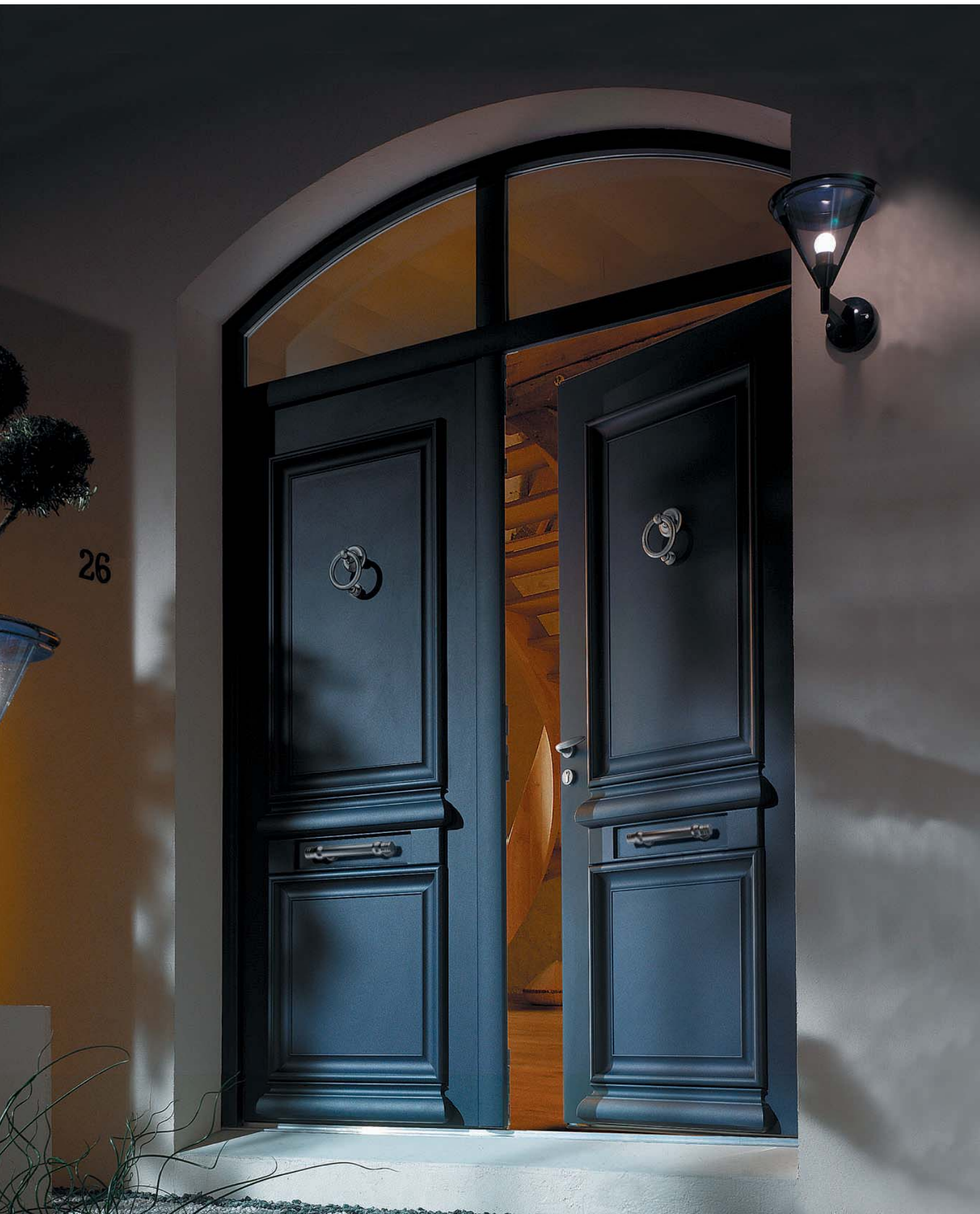
ODYSSÉE DOUBLE VANTAUX + IMPOSTE CINTRÉE (FLÈCHE DE 250 MM) AVEC MENEAU FILANT, POIGNÉE ROSACE ET HEURTOIR GRIS DÉCO BEL'M EN OPTION COMPOSITION SUR MESURE - H 2640 : OUVRANT 2150 + IMPOSTE 490 - L 1800 : 2 OUVRANTS DE 900
